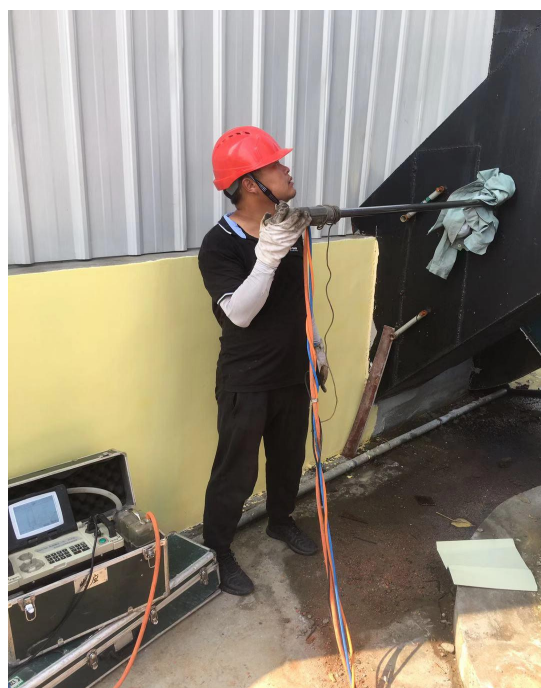
锅炉废气进口（有组织采样）
