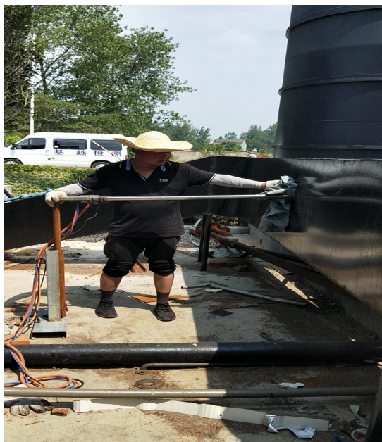
锅炉废气处理设施出口（有组织采样）
